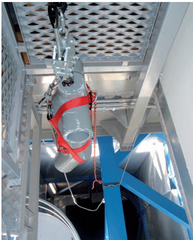
Prova di caduta di un'imbracatura. Drop test of a full body harness.
